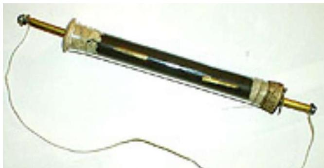
В качестве приёмника я использовал когерер. Это стеклянная трубка, в которую с торцов вставлены 2 пробки. Через пробки проходит проводник. Пространство внутри этой стеклянной трубки заполнено металлическими опилками. Сопротивление этого когерера порядка 100 ком. Каждая
